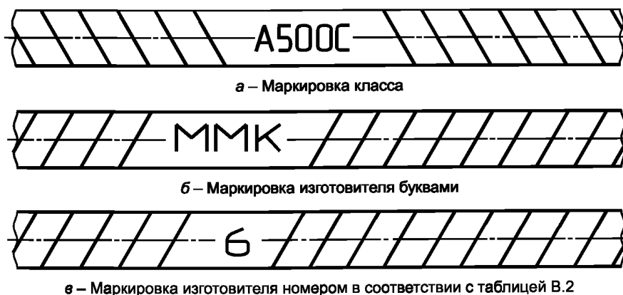
Рисунок В.1 — Маркировка проката надписью
